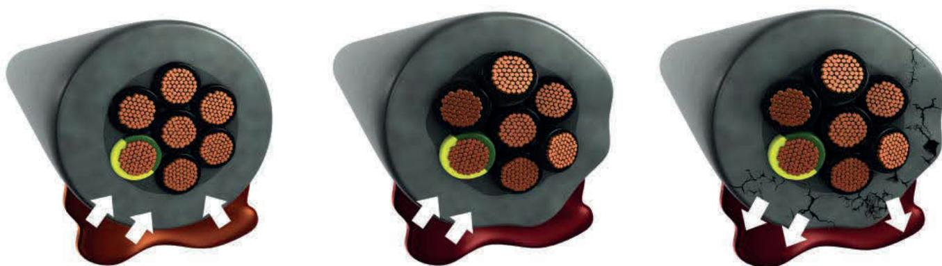
**Этап 1:** При длительном контакте технологических масел с ПВХ и полиолефиновыми соединениями, пластификаторы, которые имеются в составе кабеля, поглощают масло.
