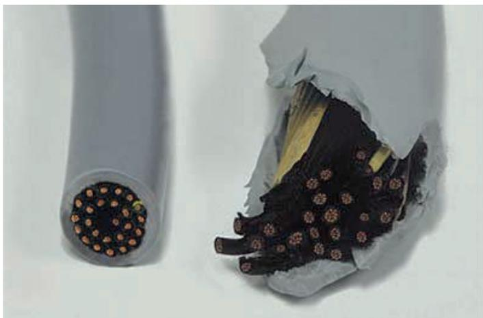
**Разрыв** – происходит из-за воздействия масла или других химикатов на ПВХ вследствие полного вымывания пластификаторов, а, следовательно, затвердевания и возможного разрыва изоляции и оболочки.
