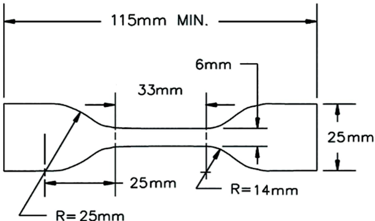
Образцы, не прошедшие испытания, состариваются согласно требованиям стандарта UL Oil Res II при 75°C в течение 60 дней. Спустя 60 дней образцы извлекаются из масла, выдерживаются в нормальных условиях минимум 16 часов, а затем испытываются на упругость и растяжение таким образом, чтобы сохранить 65% своих первоначальных свойств. Ниже следует пример результатов испытания Oil Res II:
