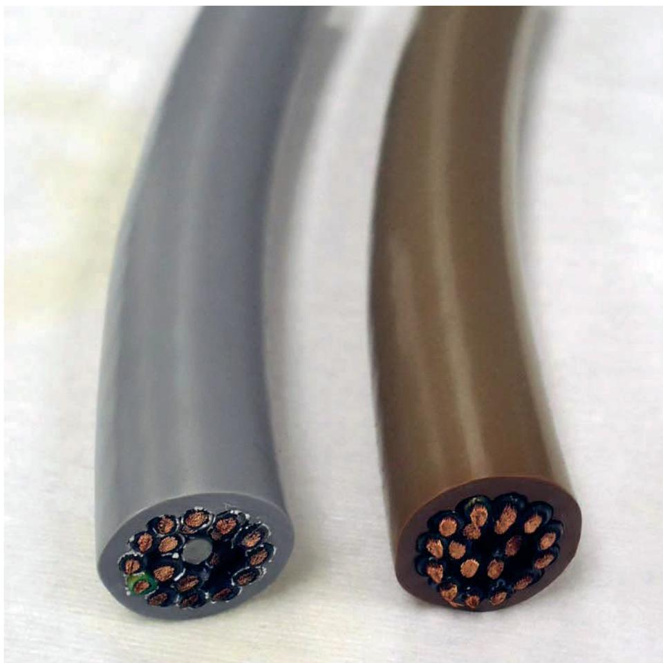
**Обесцвечивание** - происходит из-за воздействия масла или других химикатов на ПВХ: смешение пластика и колера изоляции и оболочки приводит к потере цвета.
