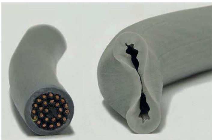
**Расплавление** – происходит из-за воздействия масла или других химикатов на ПВХ вследствие абсорбирования и соединения с пластиком, а, следовательно, размягчения и высокой эластичности смеси.
